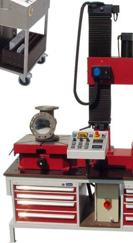
Los equipos estacionarios STM pueden realizar reparaciones en superficies de sellado de válvulas de compuerta, globo antirretorno o seguridad. Con rangos que alcanzan las 40" de diámetro, en función del modelo.
